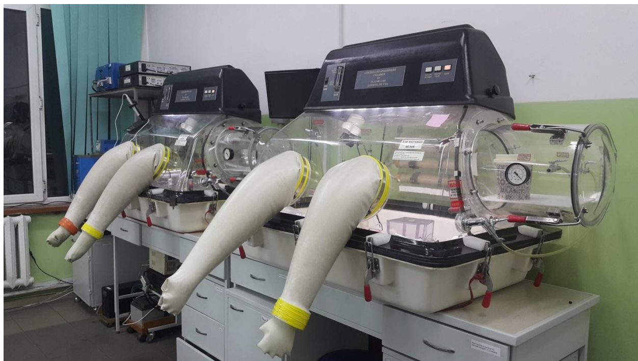
Рисунок 7 – Фотографии использованных в работе перчаточных боксов Plas Labs Lansing, MI. (США) с инертной сухой атмосферой аргона
