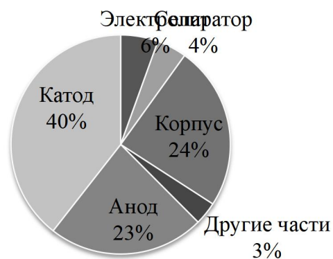
Рисунок 4 – массовое распределение компонентов в ячейке 18650 (масса ячейки 39,4 г) [52]
