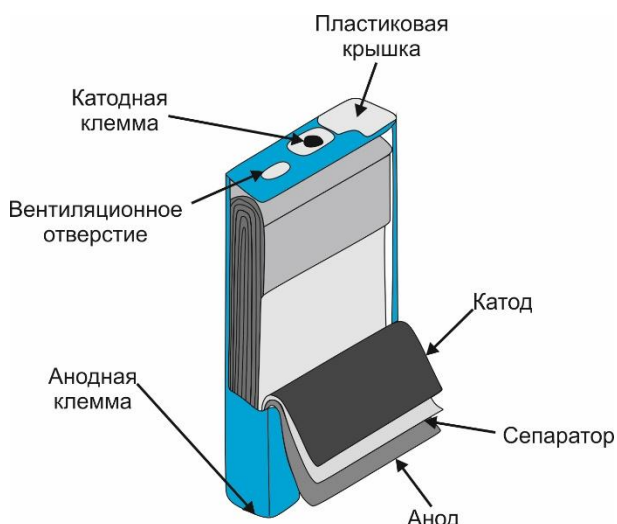
Рисунок 3 – Конструкция призматического литий-ионного аккумулятора в срезе
